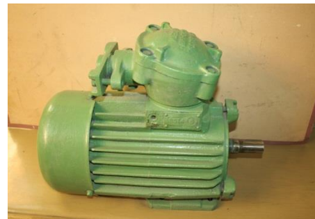
Рис. 3.2. Електродвигуни вибухозахищеного виконання марки 2ExdIIAT3 та B1Г
