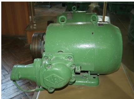
Рис. 3.2. Електродвигуни вибухозахищеного виконання марки 2ExdIIAT3 та B1Г
