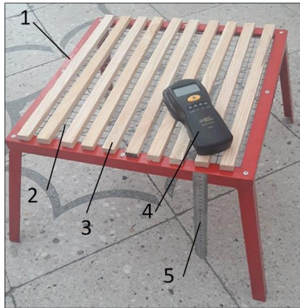
Рисунок 3.2 Прилад для визначення пожежної небезпеки в лісових масивах за умовами погоди: 1 – рама для кріплення елементів; 2 – металева сітка; 3 – дерев’яні бруски; 4 – вологомір деревини; 5 – металева лінійка (автори Попович В.В., Волоцишин А.І., Гапало А.І., 2018 р.)
