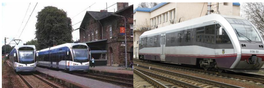
Рисунок 6.4 – Сучасні рейкові автобуси: а) – трамвай-електричка на залізничній станції; б) – міський рейковий автобус
