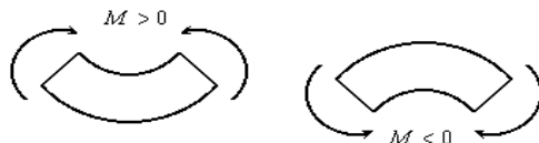
Рисунок 4.7 – Схема дії згинального моменту
