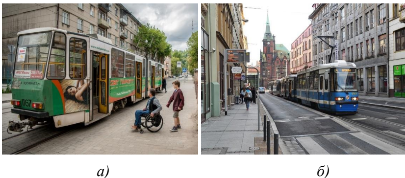
Рисунок 9.3— Місце зупинки трамвая: а – зупинка, яка несприятлива для посадки б – «віденська зупинка», де частина вулиці в зоні зупинки піднята до рівня тротуару
