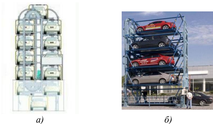
Рисунок 8.12 – Вертикальна конвеєрна система: а – схема розташування автомобілів; б – загальний вигляд
