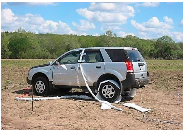
Рисунок 2.10 – Результати вибуху резервуара з воднем з робочим тиском 35МПа за умови відсутності аварійного термічного клапану [30]
