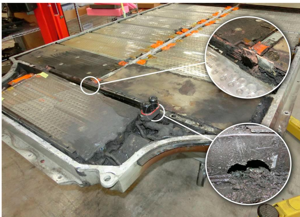
Рисунок 3.9 – Акумуляторна батарея Tesla Model S 2012 під час проведення аналізу причин займання автомобіля
