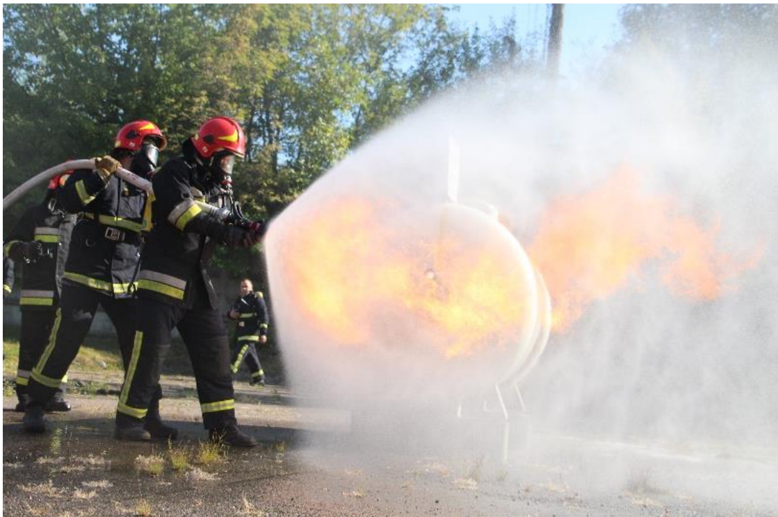
Рисунок 3.15 – Приклад тактичного використання стволів-розпилювачів для гасіння факельного горіння
