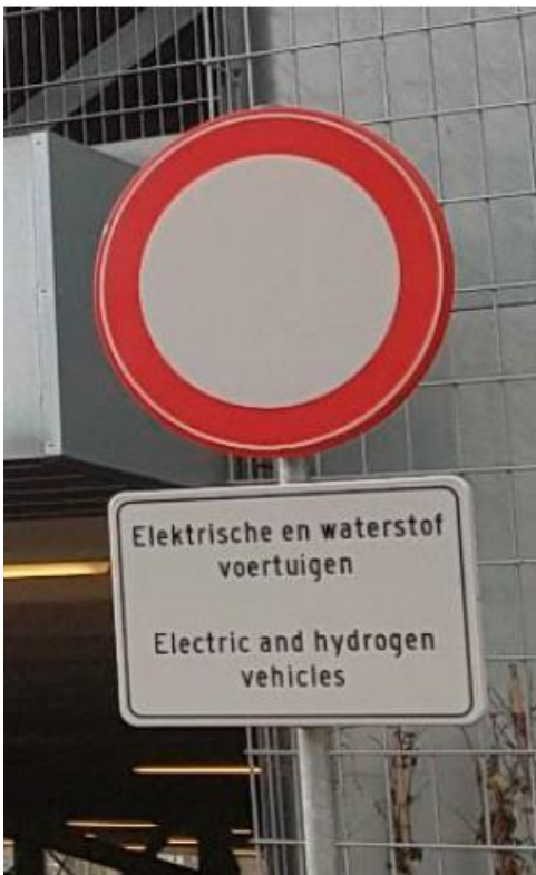
Рисунок 3.1 – Приклад дорожнього знака, що забороняє заїзд на паркінг автомобілям на альтернативних джерелах енергії (Королівство Нідерланди)
