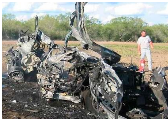
Рисунок 2.10 – Результати вибуху резервуара з воднем з робочим тиском 35МПа за умови відсутності аварійного термічного клапану [30]
