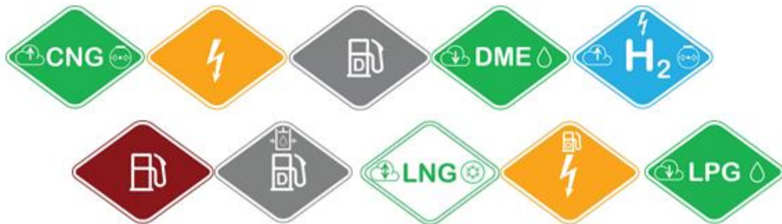
Рисунок 3.17 – Запропоновані умовні позначення для ідентифікації транспортного засобу у відповідності до Міжнародного стандарту ISO 17840
