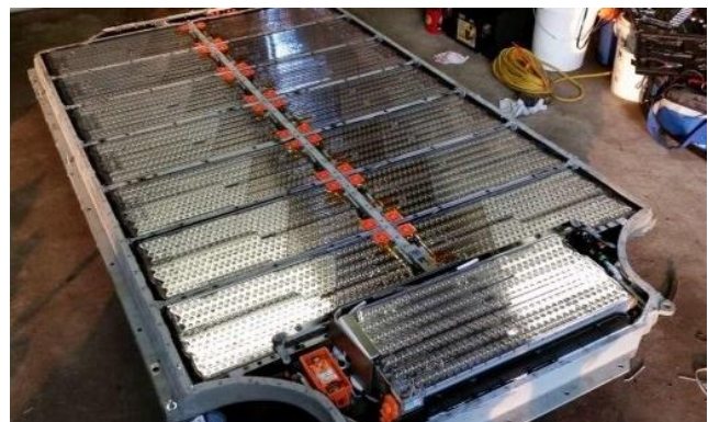
Рисунок 1.9 – Приклад елемента живлення (а) 18650 (18 x 65 мм) та розподіл в акумуляторній батареї Tesla Model S (б)
