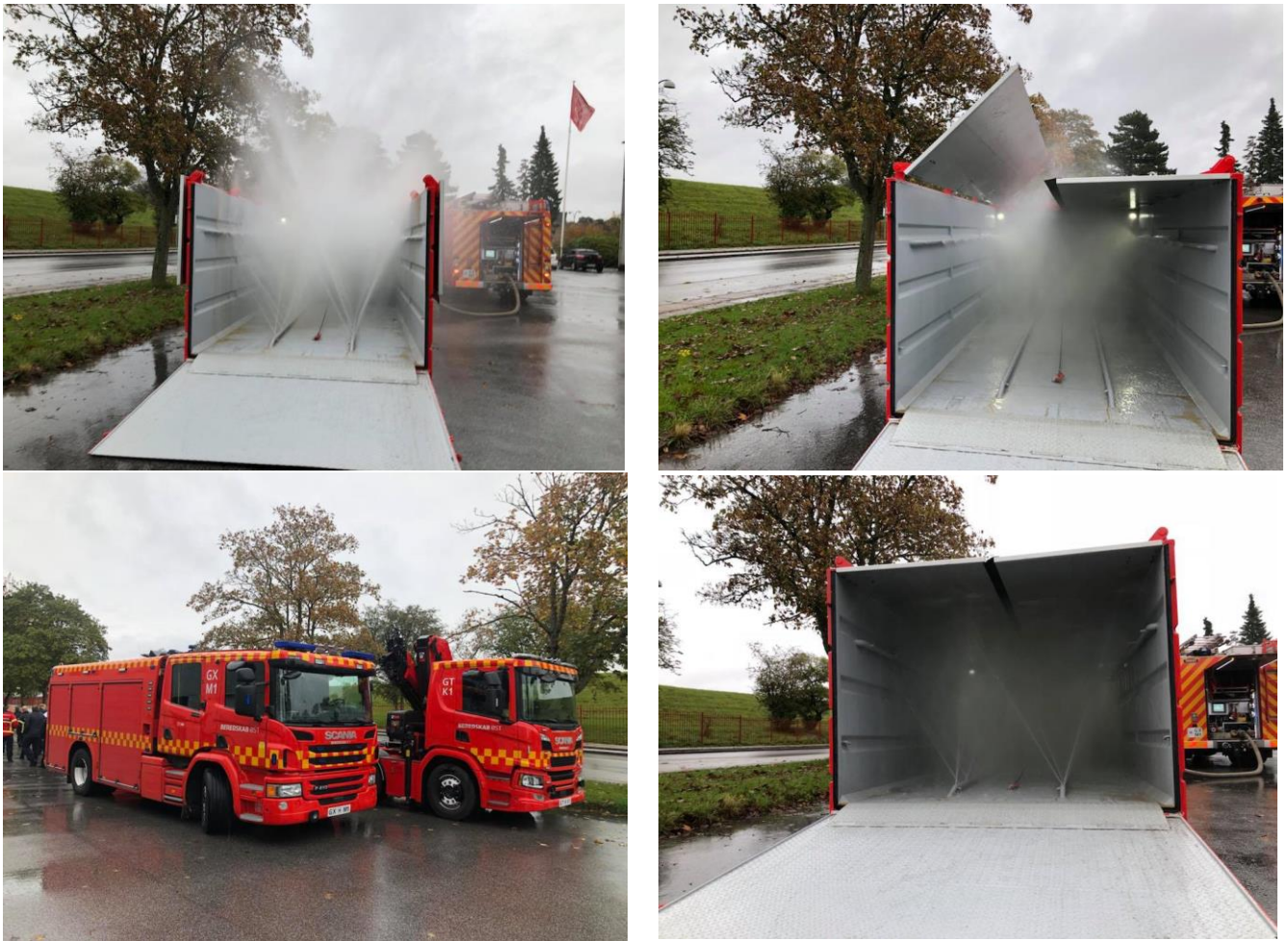
Рисунок 3.12 – Устаткування для гасіння електроавтомобілів (розробка Королівства Данії)
