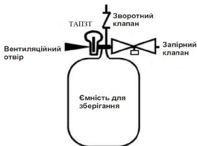
Рисунок 1.21 – Схематичне зображення балона для зберігання водню з системами безпеки
