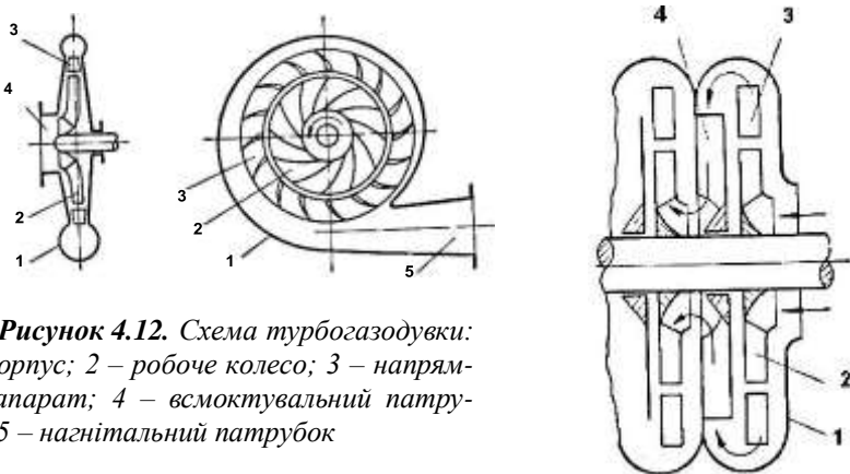
Рисунок 4.13. Схема багатоступінчастої турбогазодувки – корпус; 2 – робоче колесо; направляючий механізм; 4 – з ротний канал
