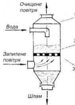
Рисунок 5.53. Схема барботажно-пінявого пиловловлювача: 1 – корпус; 2 – піна; 3 – решітка
