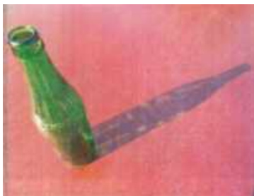
Рис.21. Фокусування сонячних променів порожньою напівпрозорою пляшкою зеленого кольору
