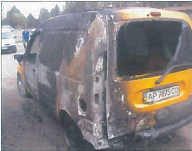
Рис.73. Пожежа автомобіля, яка виникла на його задній частині після застосування ЛЗР чи ГР як інтенсифікаторів горіння
