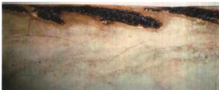
Рис.26. Загальний вигляд лінолеуму зі слідами горіння, які виникли у результаті дії сонячних променів
