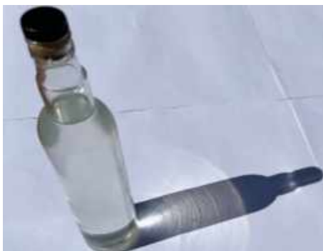
Рис.23. Фокусування сонячних променів прозорою пляшкою з водою
