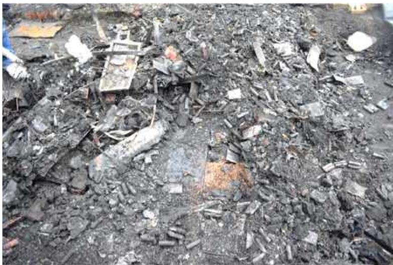
Зображення 36. Вигляд пожежного сміття (акумулятори 18650, паяльні станції, блоки живлення, лампи, елементи клавіатури) розташовані на відстані 20-22м від тильної сторони
