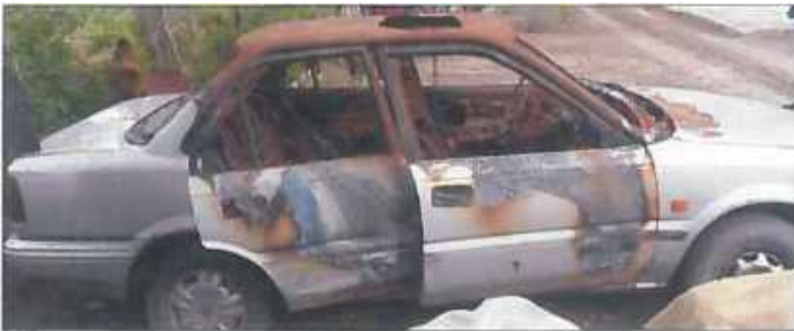
Рис.88. Характер обгорання зовнішніх поверхонь кузова АТЗ під час горіння всередині салону
