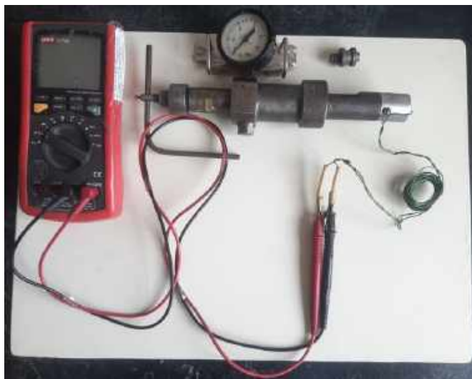
Рис.8. Установа із вимірювання електроопору вугілля Висота стовбцю (з фіксованим діаметром) пресованого вугілля повинна бути не менше 1 мм.
