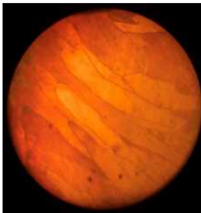
Рис.46. Мікроструктура мідного дроту із ознаками первинного короткого замикання та утворення дендритової структури
