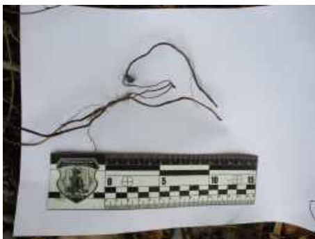
Зображення 15. Вигляд електричних проводів з ознаками короткого замикання зовні приміщення
