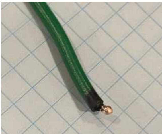
Рис.43. Кабельно-провідниковий виріб із ознаками короткого замикання
