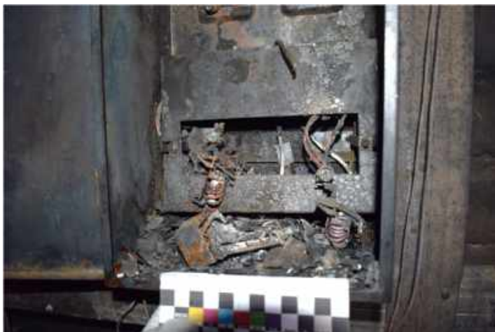
Зображення 7. Залишки подібні до механізму облікових барабанів та крокового двигуна
