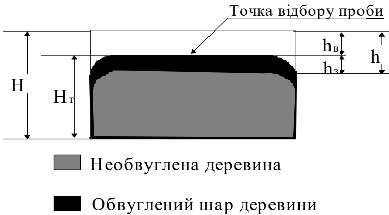
Рис.7. Геометричні розміри дерев'яної конструкції, що характеризують параметри обвуглення деревини
