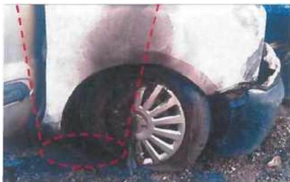
Рис.81. Термічні пошкодження в зоні задніх частин передніх коліс АТЗ, які утворюються під час стікання ЛЗР чи ГР по зливних каналах
