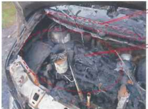
Рис.91. Характерні ознаки термічних пошкоджень при затіканні ЛЗР або ГР у моторний відсік: сліди, які утворюються на ділянці вздовж верхнього краю капота (відм. 1) та характер термічних пошкоджень вузлів і агрегатів безпосередньо в моторному відсіку АТЗ (відм. 2)
