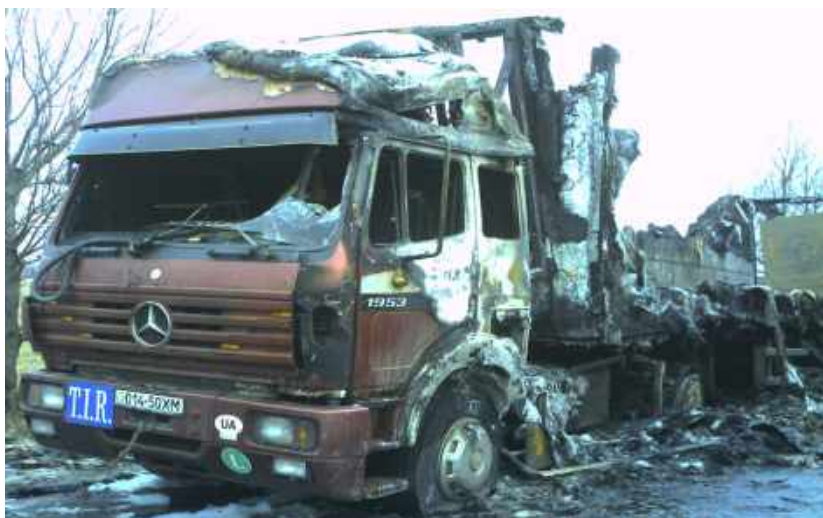
Рис.37. Вид пошкодженого вантажного автомобіля внаслідок тертя в пошкодженій маточині колеса
