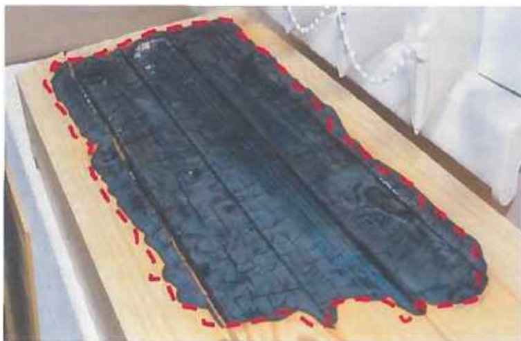
Рис.58. Чіткі межі між зугленою та необгорілою частинами деревини, що виникли після вигорання пролитих на деревину ЛЗР або ГР
