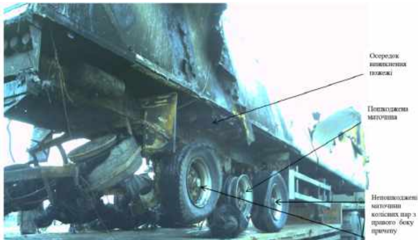
Рис. 34. Вигляд пошкодженої маточини колеса середньої осі правого борту – осередку виникнення пожежі
