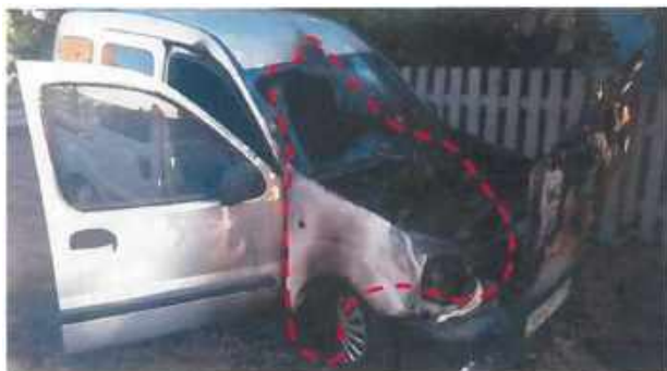
Рис.82. Термічні пошкодження капота, лобового скла, вузлів і агрегатів моторного відсіку, які утворилися внаслідок проливання ЛЗР або ГР на поверхні передньої частини АТЗ
