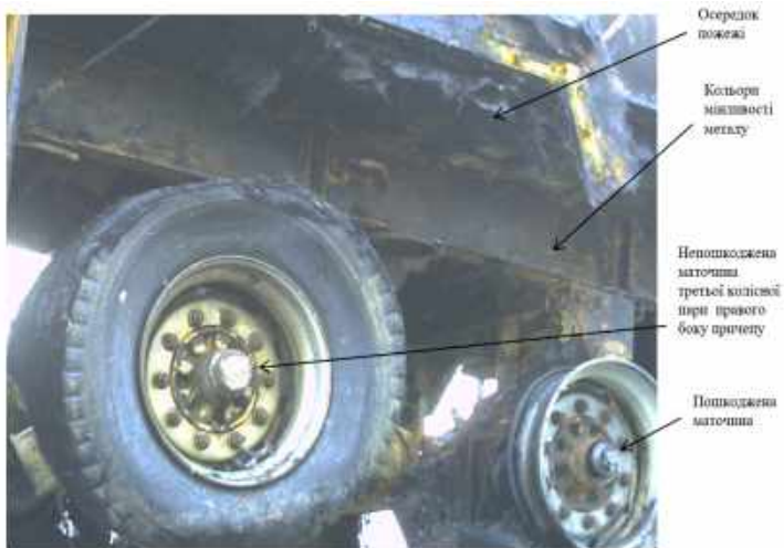
Рис.35. Збільшений вигляд пошкодженої маточини колеса середньої осі правого борту, кольору мінливості, осередку виникнення пожежі
