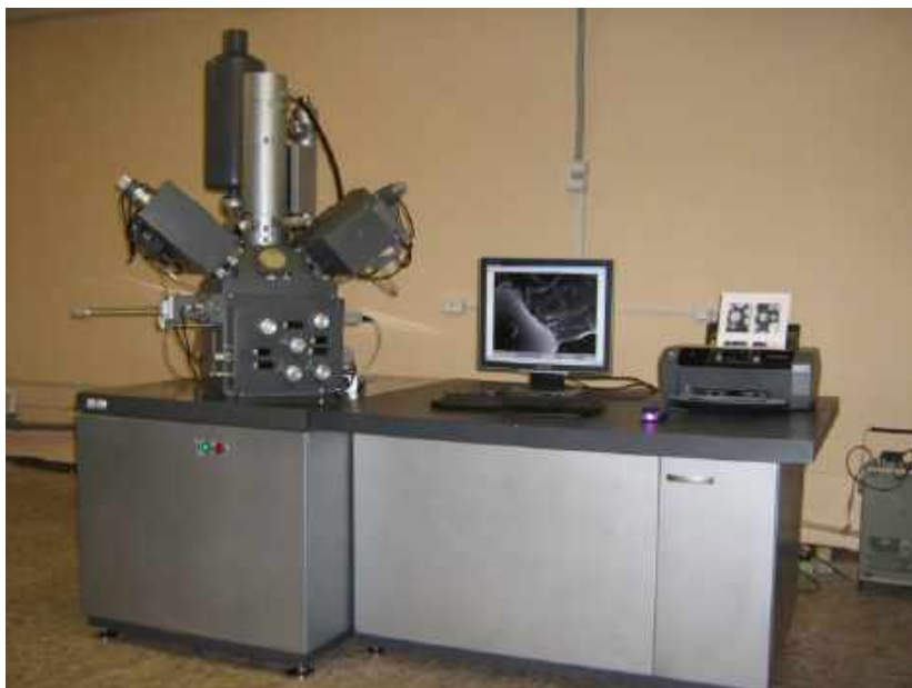
Рис.43. Електронний растровий мікроскоп для дослідження мікроструктури дроту із ознаками КЗ
