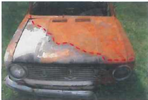
Рис.79. Сліди горіння ЛЗР чи ГР, пролитих на капот АТЗ
