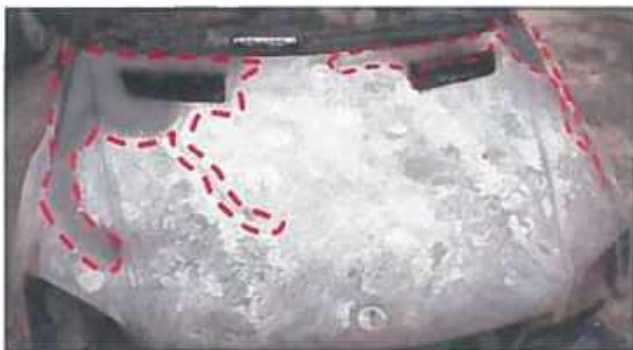
Рис.80. Сліди горіння ЛЗР чи ГР, пролитих на капот АТЗ
