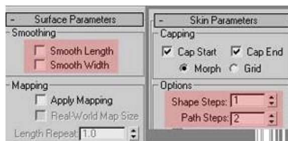
Рис.4.84. Перевірка значень параметрів Loft , Shape Steps і Path Steps
