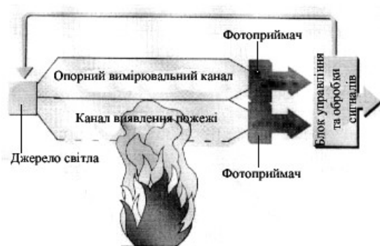
Рис. 3.29. Загальний принцип роботи ПС ESD530
