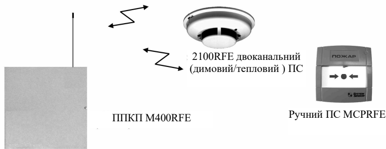
Рис. 1.6. Безпроводникова СПС компанії System Sensor
