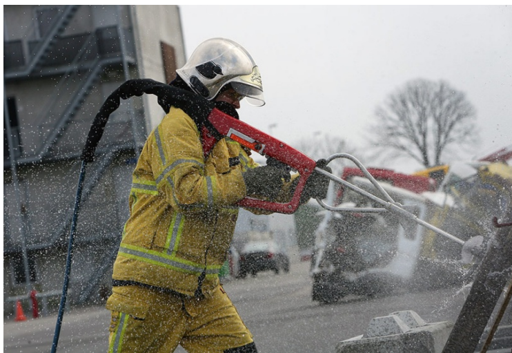
Рис. 4.20. Приклад роботи пожежника з пристроєм ColdCut Systems «Coldcut™ Cobra»
