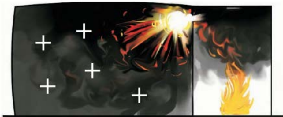
Рис.4.9. Розповсюдження горючих газів в суміжну кімнату та їхній подальший вибух
