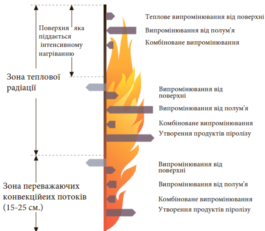
Рис. 1.6. Розповсюдження полум'я на поверхні стіни, виконаної з горючого матеріалу
