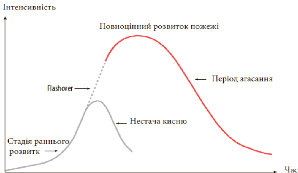
Рис. 1.15. Кінцевий етап розвитку пожежі після настання явища «Флешовер»
