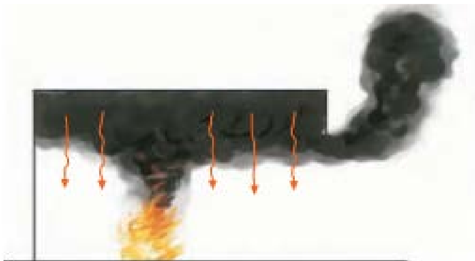
Рис. 1.13. Теплове випромінювання, що передається на паливо на рівні підлоги
