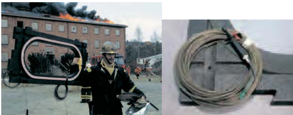
Рис.4.19. Піротехнічна рамка з вибуховим зарядом направленої дії
