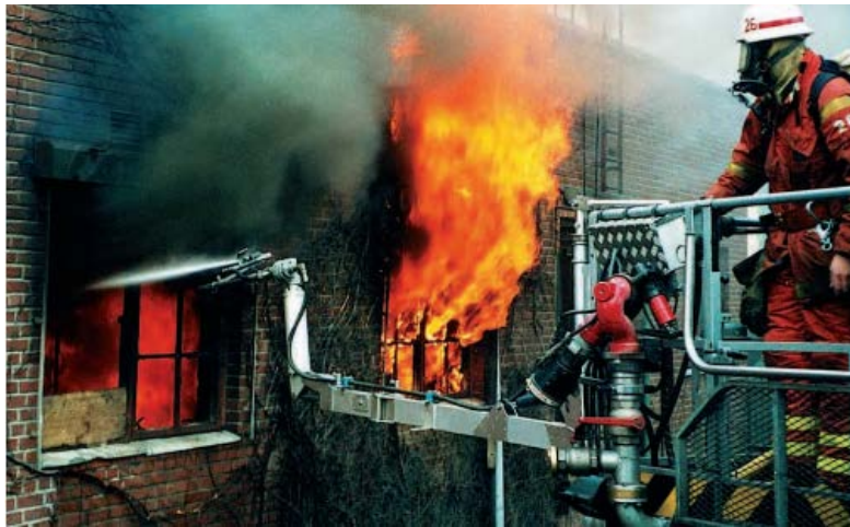
Рис. 4.21. Варіант кріплення ColdCut Systems «Coldcut™ Cobra» на колінчастий автопідіймач
