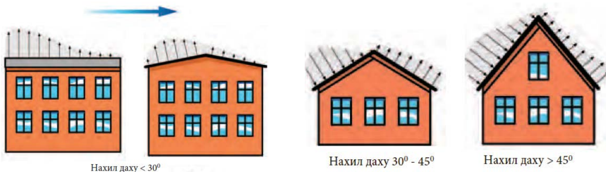
Рис. 2.13. Розподіл тиску вітру на поверхні даху будівлі залежно від кута нахилу даху
