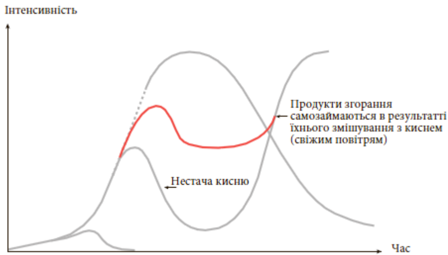
Рис.1.18. Процес самозаймання продуктів горіння і перехід пожежі в стадію «Флешовер»
