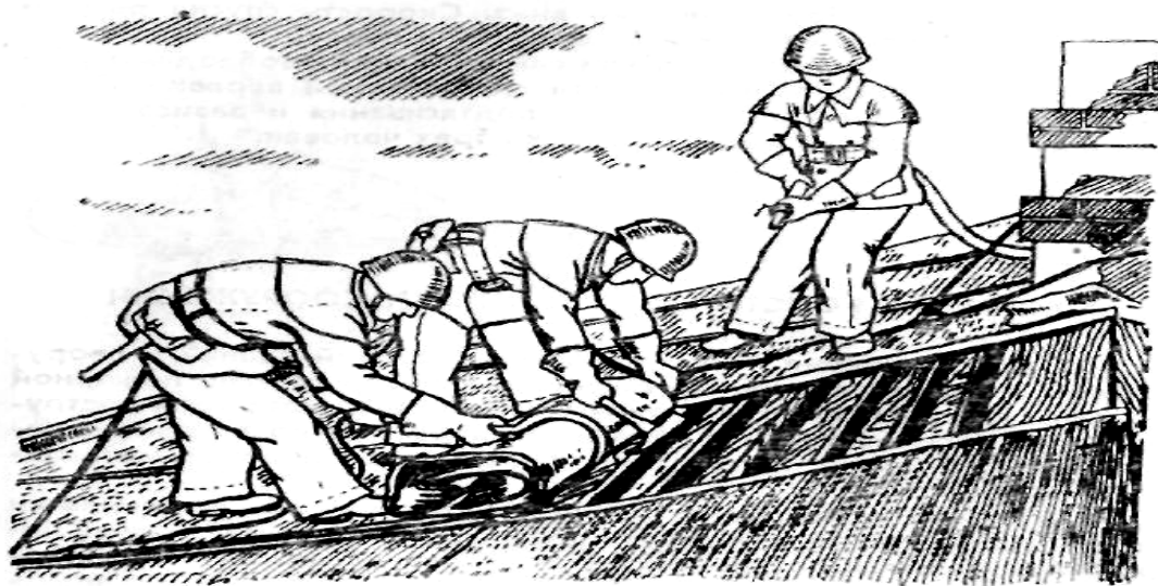
Рис. 4.18. Розкриття металевої покрівлі за допомогою гака легкого та поясної пожежної сокири для виявлення прихованого осередку пожежі або вилучення продуктів горіння
