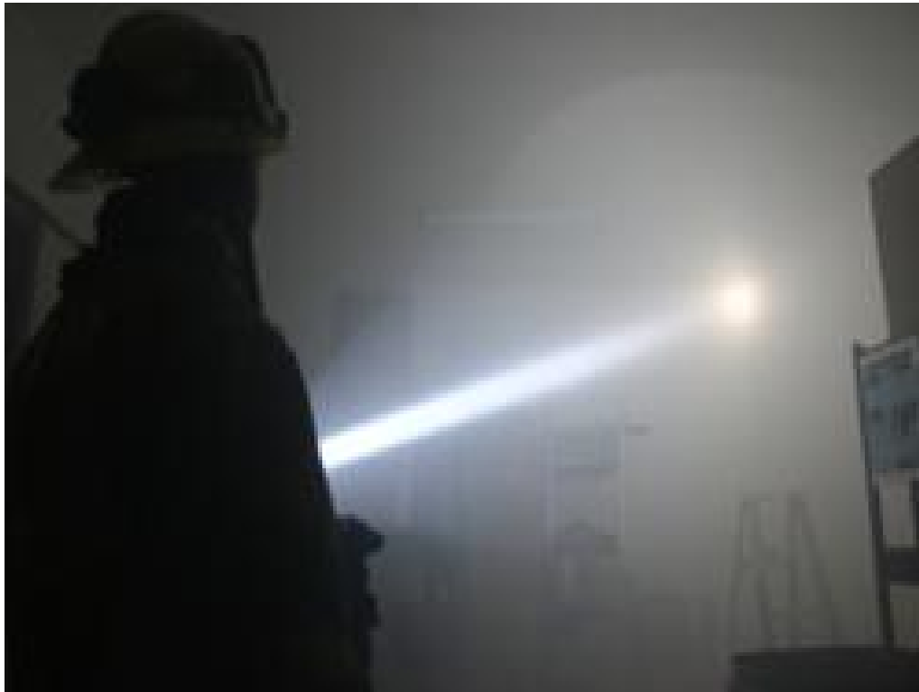
Рис. 2.1. Визначення оптичної густину диму за видимістю предметів, освітлених електричним ліхтарем
