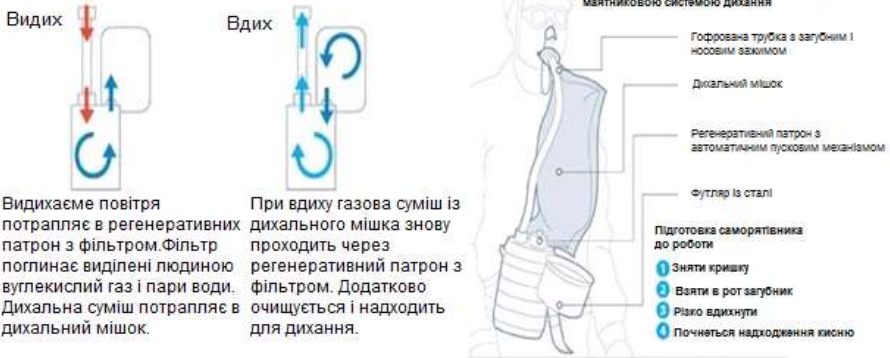
Рис. 6.5. Принцип роботи та правила включення в саморятівник
