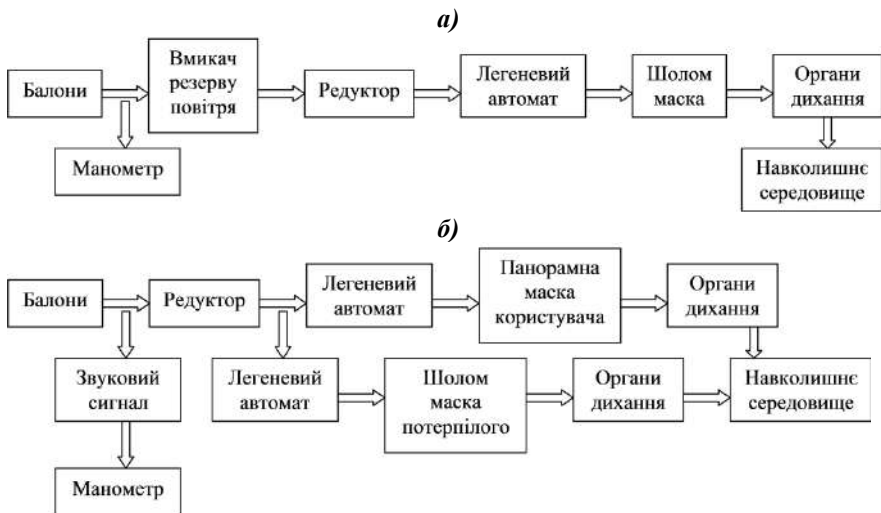
Рис. 2.8. Принцип роботи апарата АСВ-2 на прикладі блок-схем:
