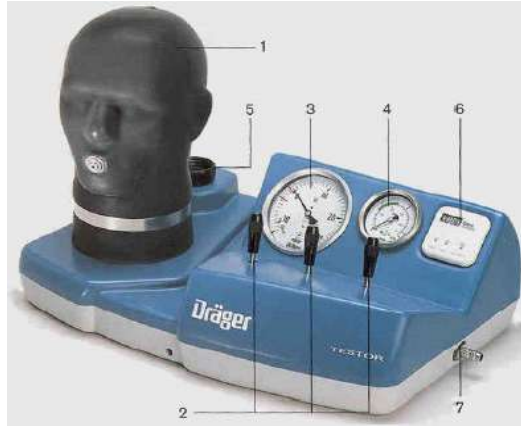
Рис. 9.11. Загальна будова прилад "Testor":
