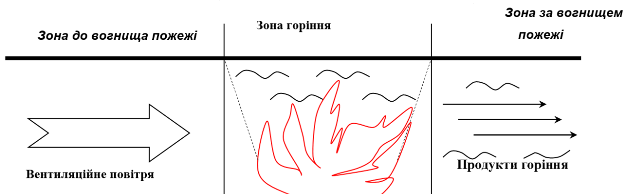
Рисунок 25.2 - Схема поширення пожежі в тунелі
