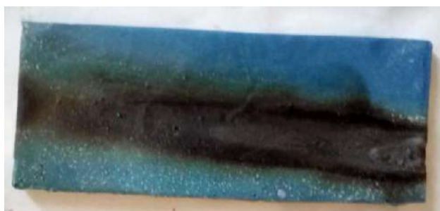
Рис. 4.5. Зразок композиції з вмістом антипірена 66 мас. ч. після випробувань на групу горючості
