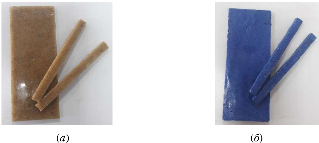
Рис. 5.2. Деревостружкові зразки з використанням епоксидних клейових композицій: а – без антипірена; б – з антипіреном
