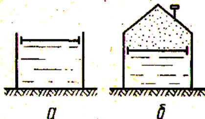
Рис. 3.6 Резервуар з дахом, що плаває, (а) і з плаваючим понтоном (б)
