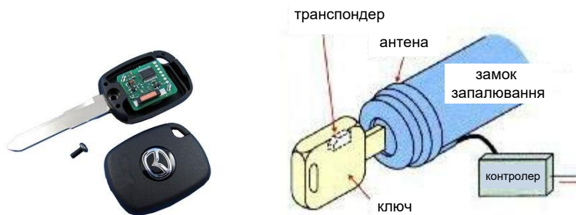
Рисунок – 5.37 Зовнішній вигляд транспондера та улаштування системи
