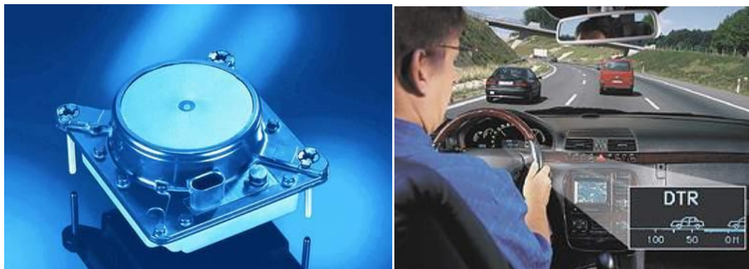
Рисунок – 6.29 Адаптивний круїз-контроль: а) ультразвуковий датчик; б) індикація роботи системи
