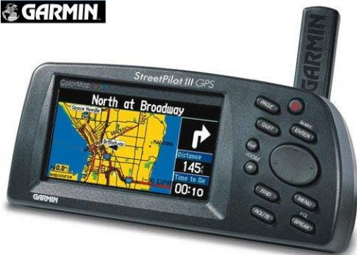
Рисунок – 5.27 Автомобільна навігаційна система Garmin StreetPilot III: а — загальний вид системи Garmin StreetPilot III; б — дисплей в навігаційному режимі; в — режим вибору пункту призначення; г — дисплей в режимі маршрутного комп'ютера
