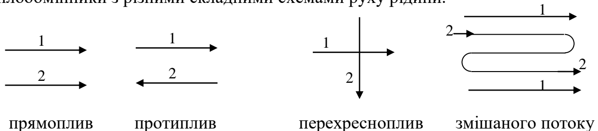
Рис. 19. Схеми руху теплоносіїв в теплообмінних апаратах
