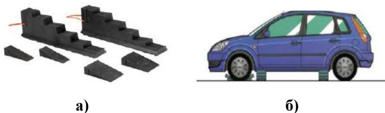
Рисунок 2.34. Стабілізація піднятого вантажу за допомогою блоків – підставок: а) загальний вигляд блоків-підставок; б) приклад фіксації автомобіля блоками-підставками
