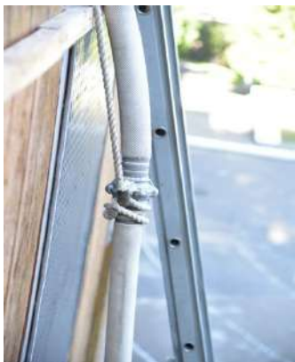
Рисунок 2.64. Закріплення рукавної лінії на висоті за підвіконня будівлі за допомогою рукавної затримки.
