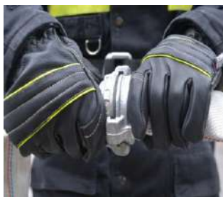
Рисунок 2.61. З'єднання напірних рукавів між собою
