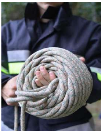
Рисунок 2.23. Рятувальна мотузка, змотана у клубок
