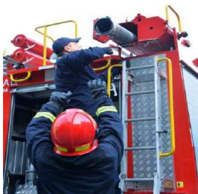
Рисунок 2.53. Зняття всмоктувального рукава з автоцистерни
