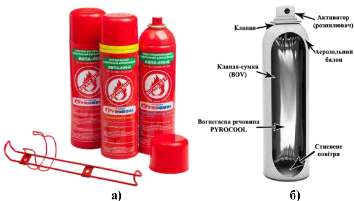
Рисунок 2.8. а) Загальний вигляд пристрою вогнегасного водопінного аерозольного; б) будова BBPA-400
