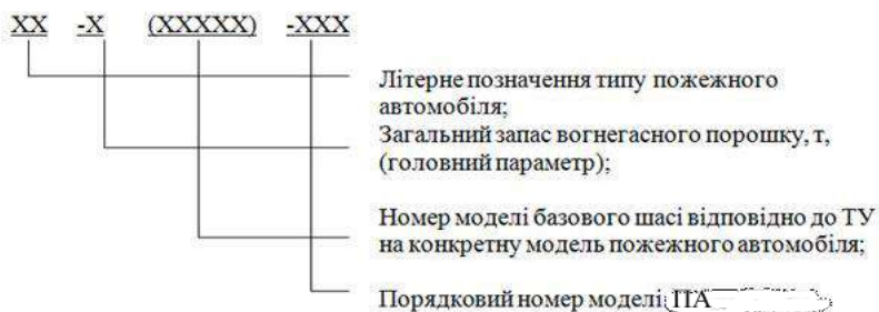
Рисунок 2.115. Структурна схема позначення пожежних автомобілів типу АП залежно від головного параметра і базового шасі
