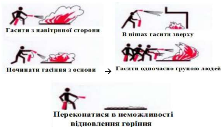
Рисунок 2.14. Порядок застосування вогнегасників
