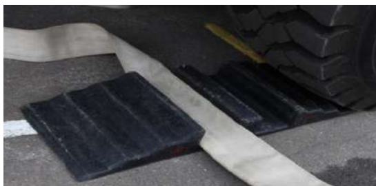
Рисунок 2.71. Прокладання рукавної лінії через рукавний місток
