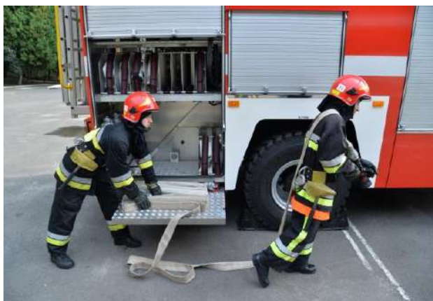
Рисунок 2.58. Прокладання напірних рукавних ліній які складені способом “Гармошка”
