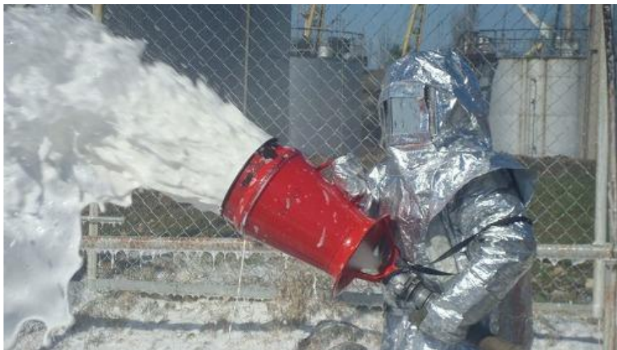
Рисунок 8.3 – Отримання піни середньої кратності за допомогою ежекційного піногенератора
