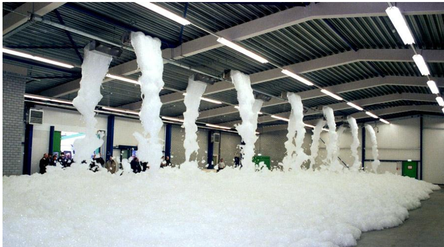
Рисунок 8.5 – Заповнення простору приміщення піною високої кратності
