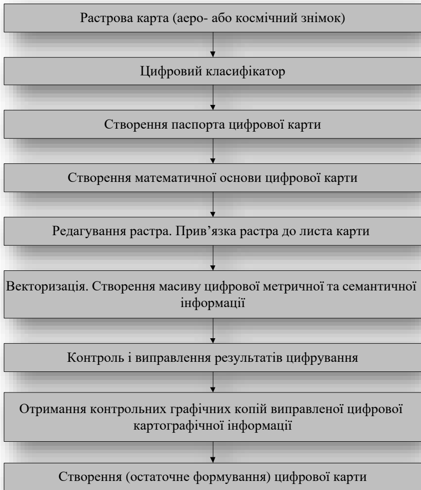
Рис. 1.1. Технологічна схема створення цифрових карт за растровими картографічними зображеннями
