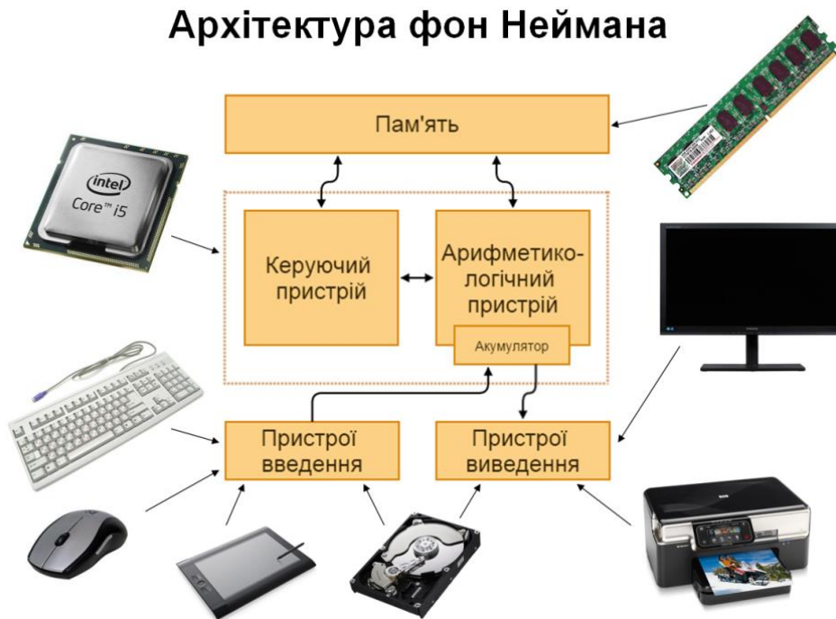
Рисунок 1.13 – Типова архітектура ЕОМ (персонального комп'ютера)
