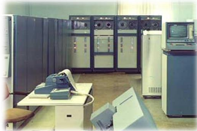
Рисунок 1.7 – Загальний вигляд ЕОМ III покоління
