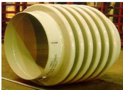
Рисунок 8.15 – Загальний вигляд компенсатора
