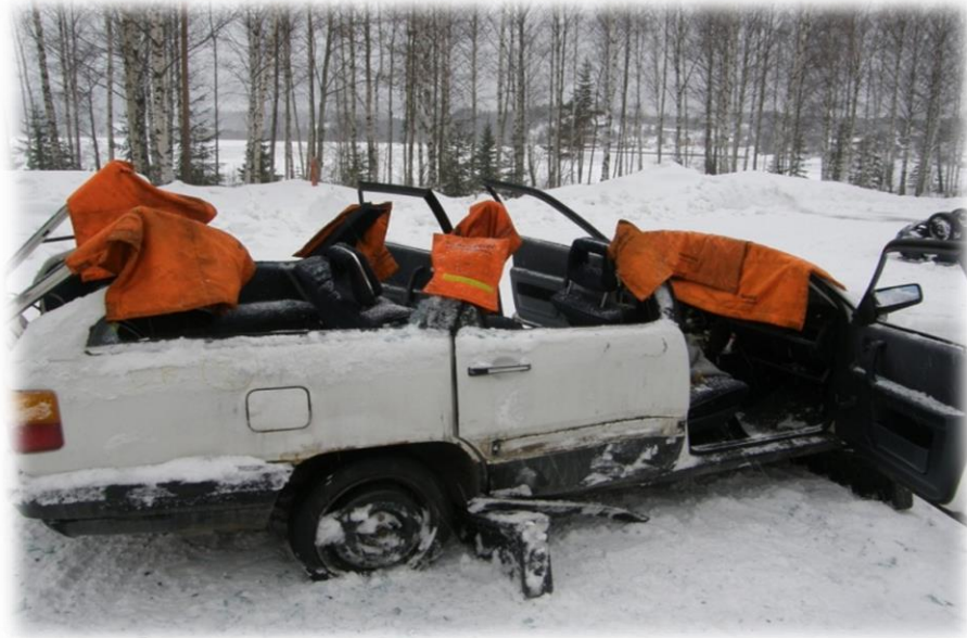
Рисунок 5.11 – Встановлення захисних засобів
