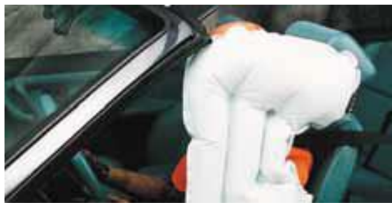
Рисунок 3.13 – Подушка безпеки, розташована в боковині крісла
