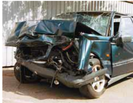
Рисунок 3.20 – Деформація завдяки зонам зім'яття
