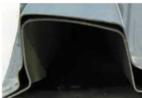
Рисунок 3.2 – Поперечний переріз середньої стійки, мод. 1996
