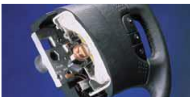
Рисунок 3.10 – Поперечний переріз нерозгорнутої передньої подушки безпеки
