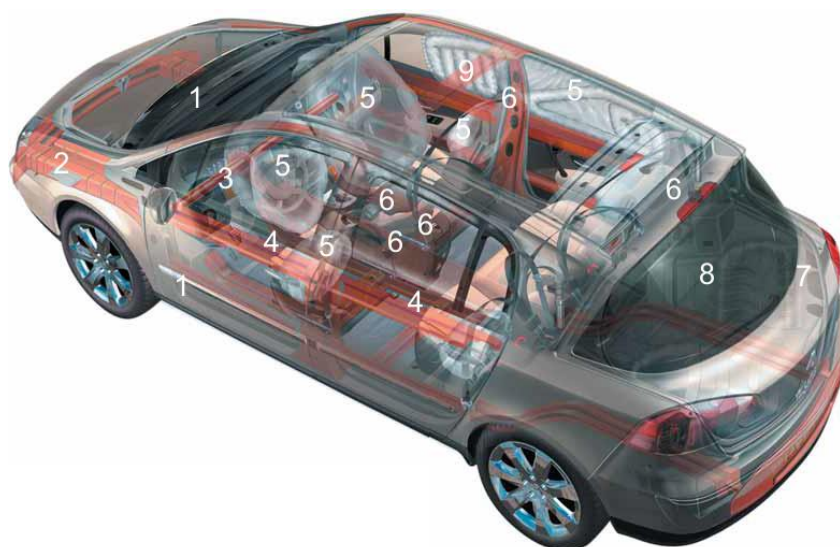
Рисунок 3.6 – Конструкція удосконалення захисних пристроїв
