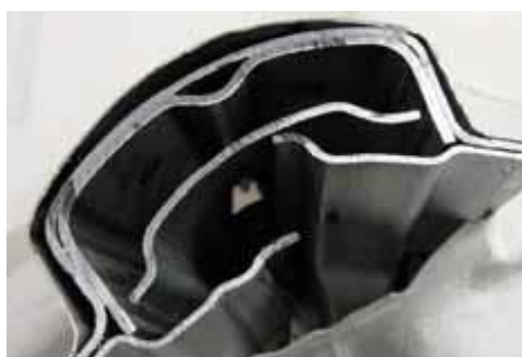
Рисунок 3.3 – Поперечний переріз середньої стійки, мод. 2002
