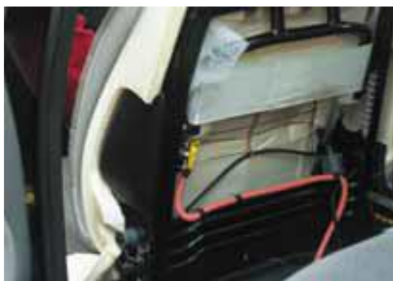
Рисунок 3.25 – Система автоматичного відключення АКБ
