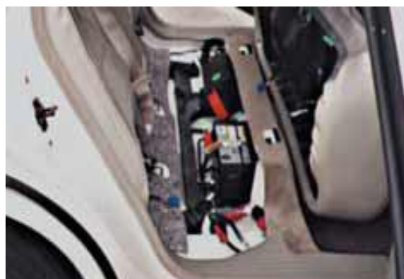
Рисунок 3.24 – Акумуляторні батареї під заднім сидінням
