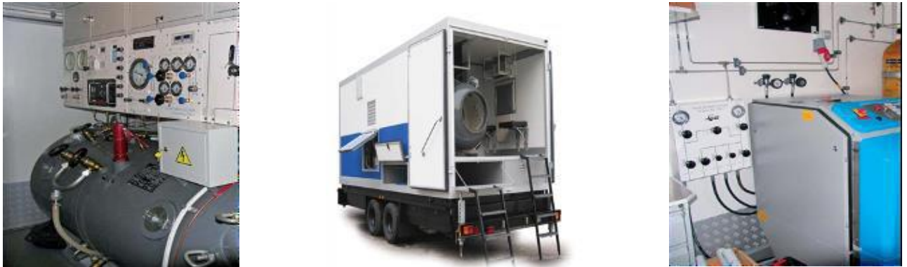
Рис. 3.25. Оформлення контейнерного водолазного комплексу
