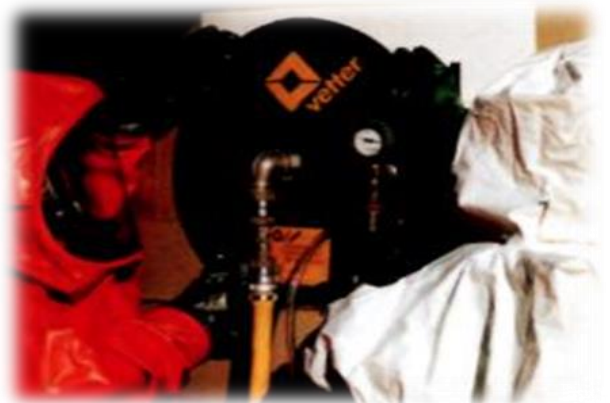
Рис. 1.6. Локалізація витоків НХР за допоногоу спеціальних ущільнювачів
