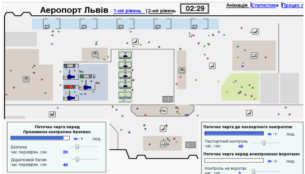
Рис. 4.2 Мультиагентна модель життєвого циклу продукту інфраструктурного проекту аеропорту «Львів»: а) концептуальна модель; б) експериментальна апробація в середовищі Anylogic
