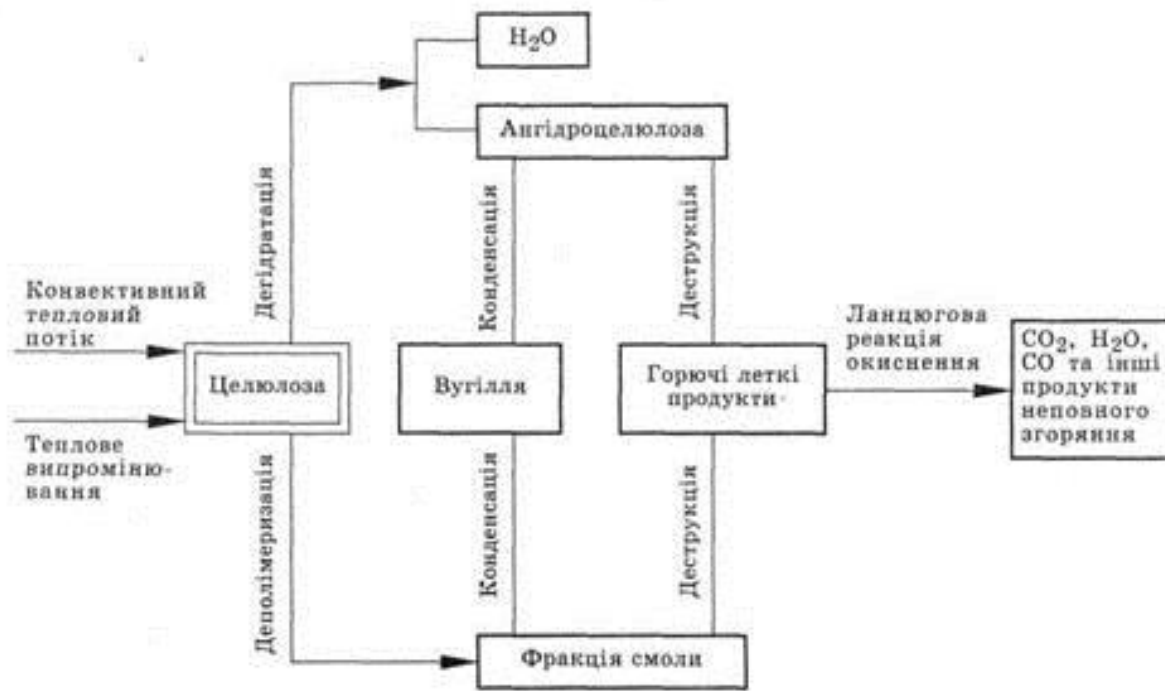
Рис. 1.8. Процес термічних перетворень целюлози
