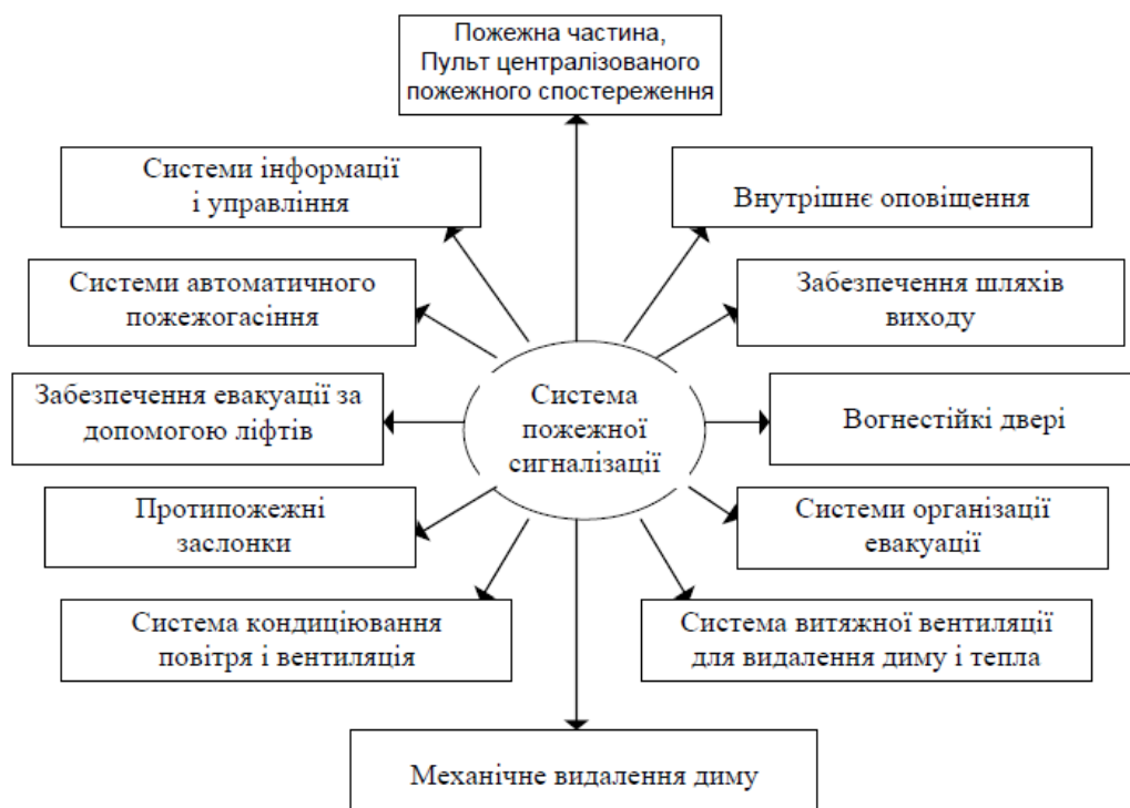
Рис. 1.7. Система пожежної сигналізації (СПС) для протипожежного захисту об'єкта [237]
