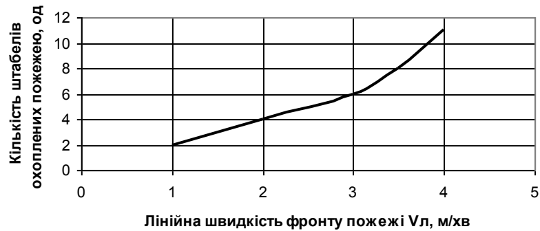
Рис. 4.15. Вплив лінійної швидкості фронту пожежі при попутньобоковому вітру V_в = 4 м/с на кількість штабелів охоплених пожежею
