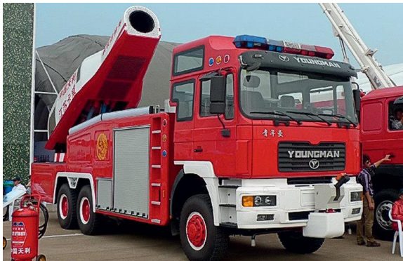
Рис.1.26. Китайська пожежна машина із газотурбінним насосом від літака винищувача
