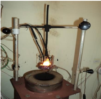
Рис. 3.9 Вигляд ізоляційного матеріалу а) під час випробування; б) після випробування
