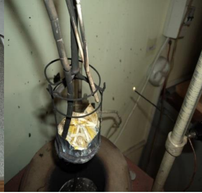
Рисунок 3.6 – Розміщення зразка у тримачі ОТП
