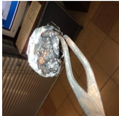
Рис. 3.9 Вигляд ізоляційного матеріалу а) під час випробування; б) після випробування
