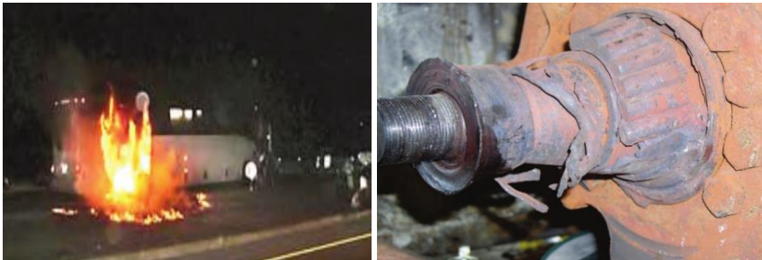
Рисунок 1.15 – Зовнішній вигляд автобуса під час пожежі, причиною якої став вихід з ладу підшипників осі маточини колеса
