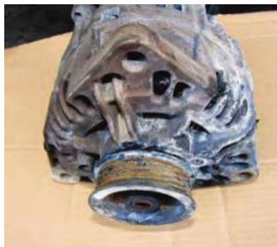
Рисунок 1.12 – Зовнішній вигляд генератора, який став причиною пожежі автобуса
