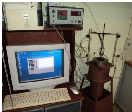
Рисунок 3.4 – Загальний вигляд установки для визначення температури займання та самозаймання ізоляційних матеріалів
