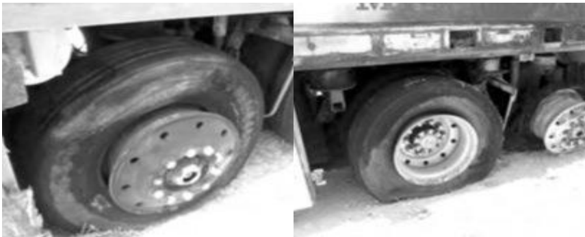
Рисунок 1.14 – Зовнішній вигляд колеса автобуса, яке стало причиною пожежі
