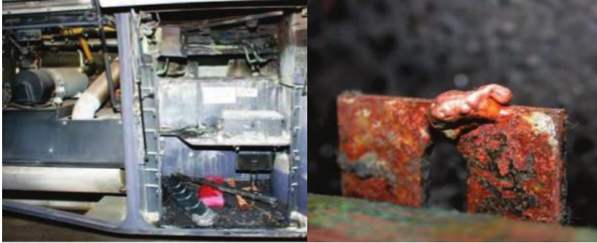
Рисунок 1.13 – Зовнішній вигляд автобуса після пожежі, причиною якої стало КЗ
