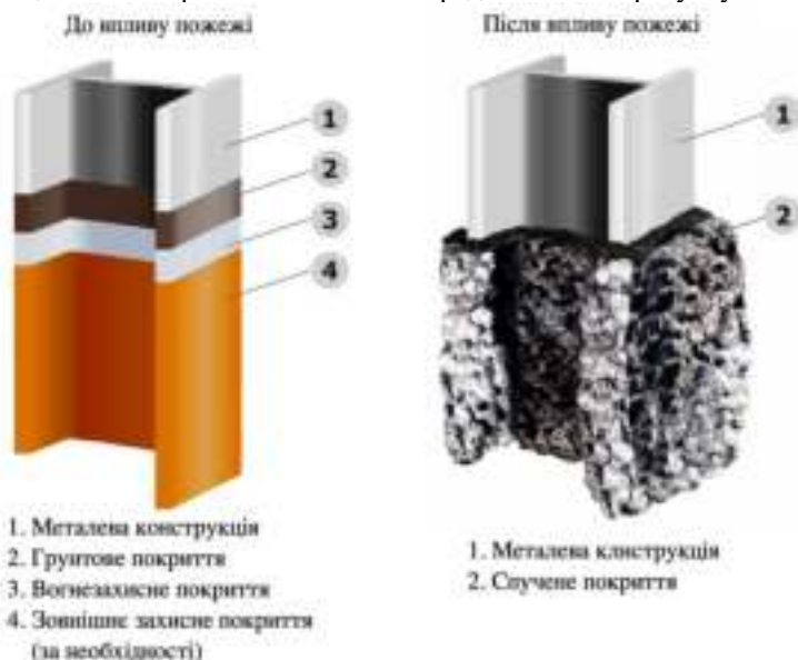
Рисунок 1 – Вигляд будівельної металевої конструкції з нанесеним вогнезахисним інтумесцентним покриттям до та після пожежі
