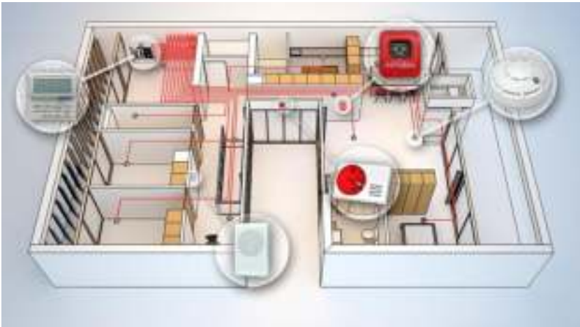
Рисунок 1 – план-схема розташування датчиків пожежної сигналізації
