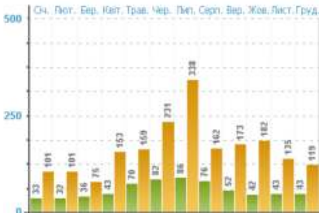
Рисунок 2 – Середня місячна і максимальна кількість опадів (мм) з поправками на змочування (за даними «Укргідрометцентру» на станції Рава-Руська з 1899 року)
