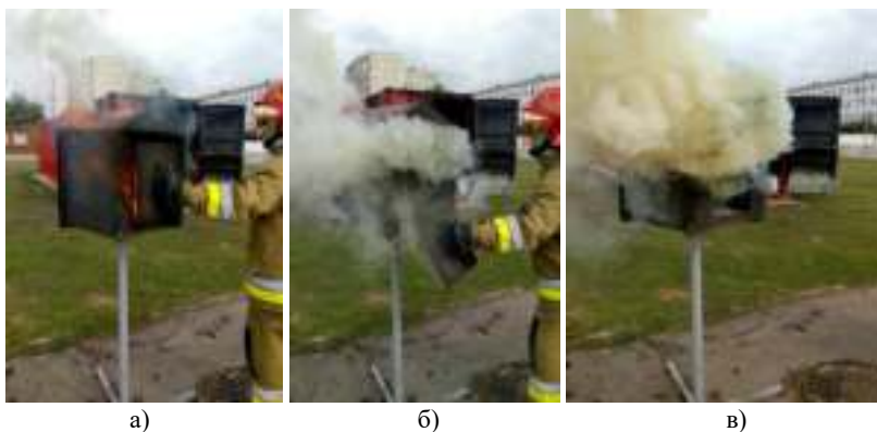
Рисунок 1 – Загальний вид управління газообміном при розвитку пожежі:
