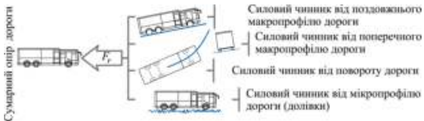
Рисунок 1 — Силві чинники, що формують опір дороги пересуванню автомобіля
