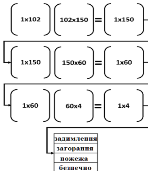
Рисунок 3 – Структурна схема порядку множення матриць в алгоритмі
