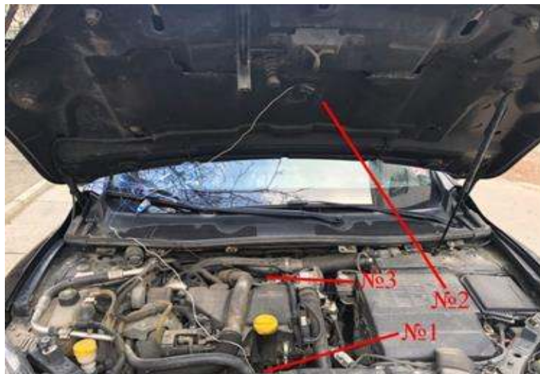
Рисунок 1 – Місця розміщення трьох термопар у моторному відсіку автомобіля
