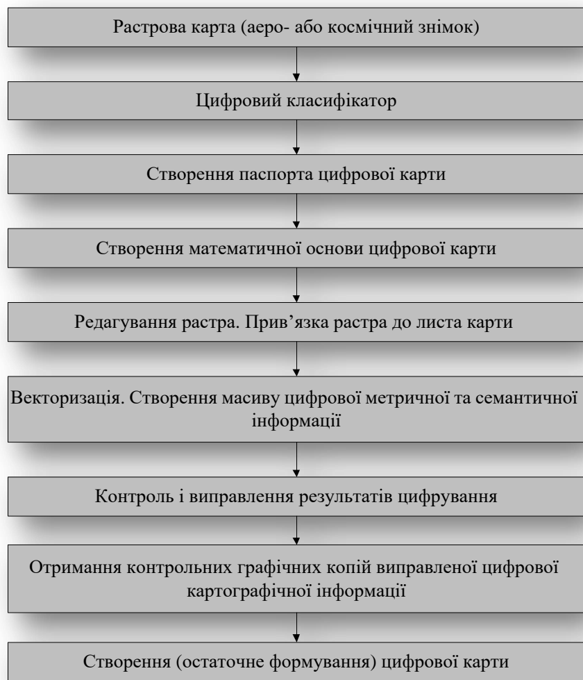
Рисунок 3.1 – Технологічна схема створення цифрових карт за растровими картографічними зображеннями
