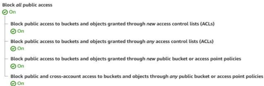
Рисунок 3 – налаштування для блокування публічного доступу до bucket'а
