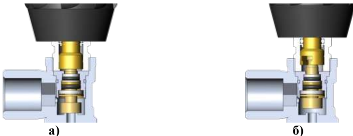
Рисунок 7 – Принцип роботи запірного вентиля захисного дихального апарата ПОСТАУЭР-SL: а) в закритому положенні, б) у відкритому положенні
