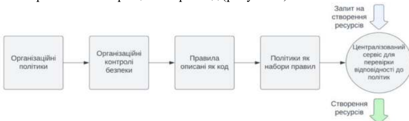
Рисунок 1 – Спрощена схема реалізації підходу “Безпека як код”
