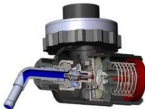
Рисунок 3 – Легеневий автомат виробництва фірми MSA у розрізі
