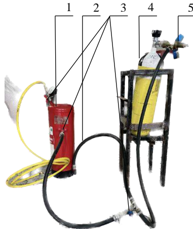
Рисунок 1 – Лабораторна установка типу вогнегасника для генерації компресійної піни: 1 – корпус вогнегасника (ємність для змішування води та ПУ); 2 – з'єднувальні шланги; 3 – запірні вентилялі; 4 – балон із стиснутим повітрям; 5 – редуктор із манометром.
