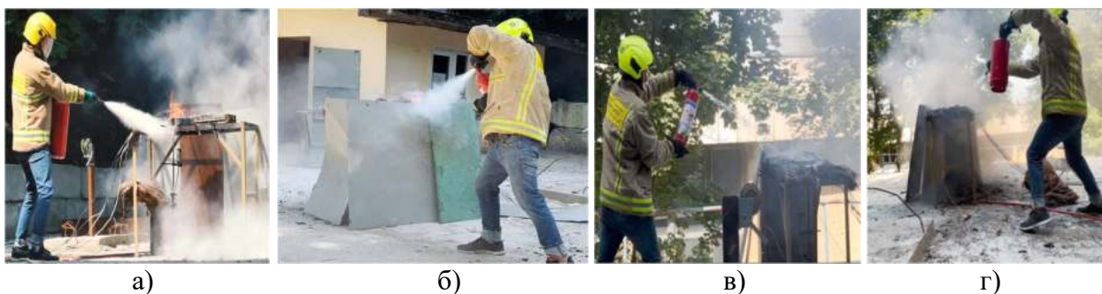
Рисунок 2 – Використання різних типів переносних вогнегасників під час гасіння літій-іонного модуля: а) ВП-5(з); б) BVK-5; в) VVP-5(з); г) BB-5(з)
