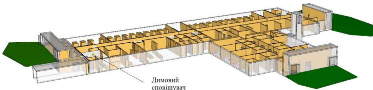
Рисунок 2 – Місце встановлення димового сповіщувача, на висоті 2,95 м від чистої підлоги
