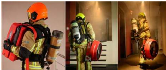
Рисунок 3 – Перенесення димовсмоктувача до місця призначення одним газодимозахисником
