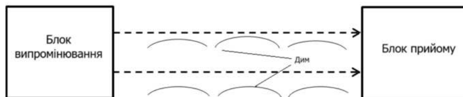
Рисунок 1 – Схема роботи лінійного димового пожежного сповіщувача
