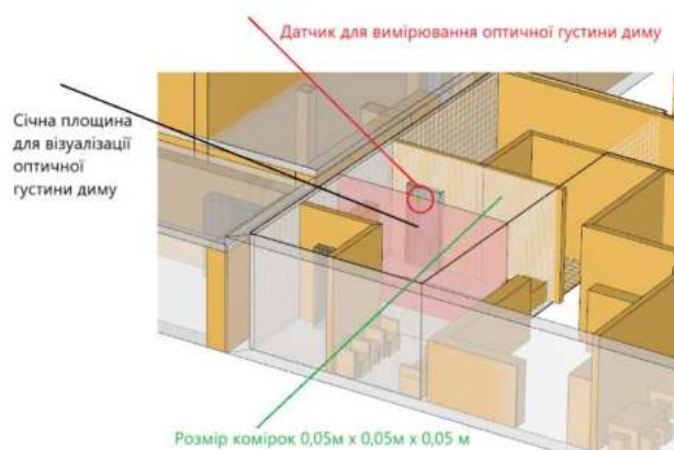
Рисунок 3 – Місце розміщення січної площина та датчика
