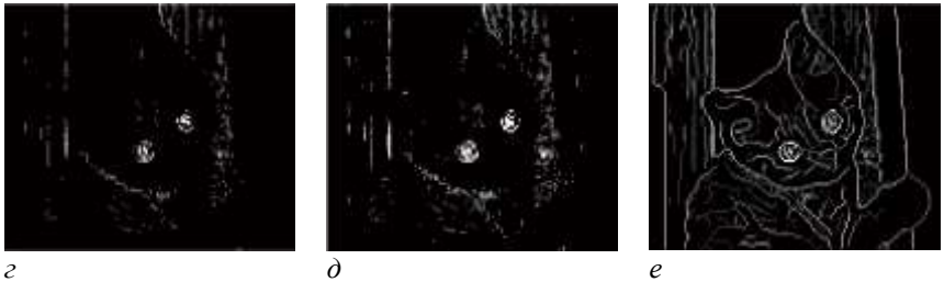
Рис. 2. Аналіз вхідного контейнера C_v : a – зображення «cat.jpg» (128x108 пікс., 14 КБ) b , v – визначення контурів L_v алгоритмами Собеля та Кенні; c , d – визначення контрасту L_c при c_\tau = 0,2 та c_\tau = 0,15 ; e – загальна оцінка L для алгоритму Кенні та c_\tau = 0,15
