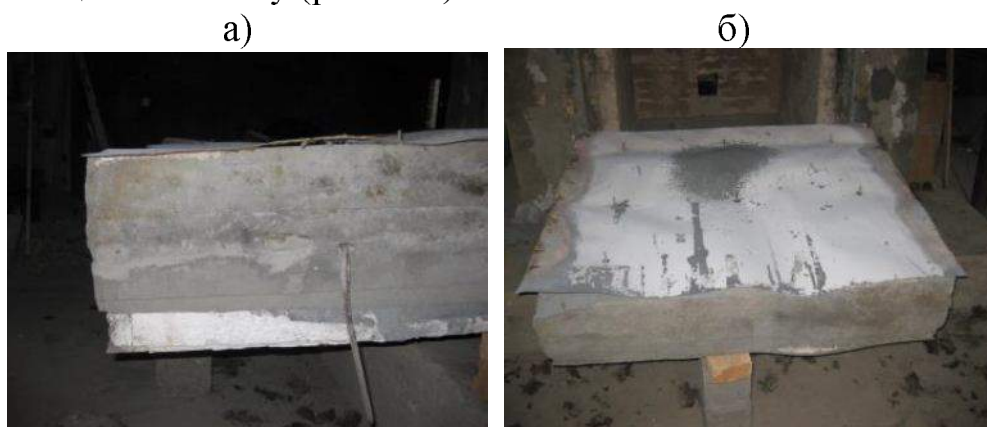
Рисунок 4.18. Вигляд дослідного зразка марки СПППБ-1(а), СПППБ-2(б) після проведення вогневого випробування.
