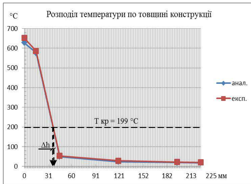
Рисунок 4.29. Співставлення графіків теоретичних та експериментальних досліджень огорожувальної конструкції марки СФБ на 100-ій хв
