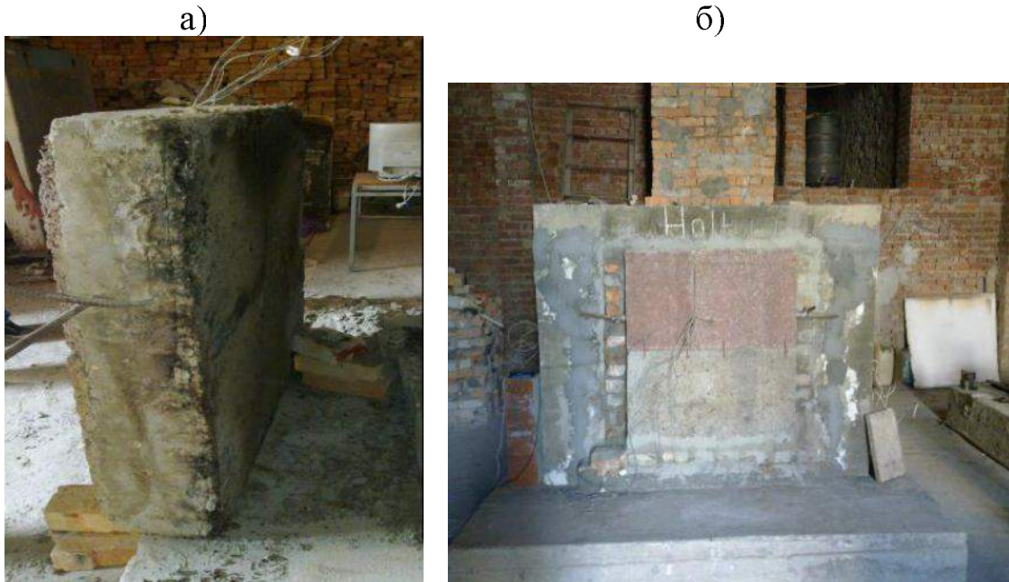
Рисунок 4.22. Вигляд дослідного зразка марки СФБ-1,2 після випробування
