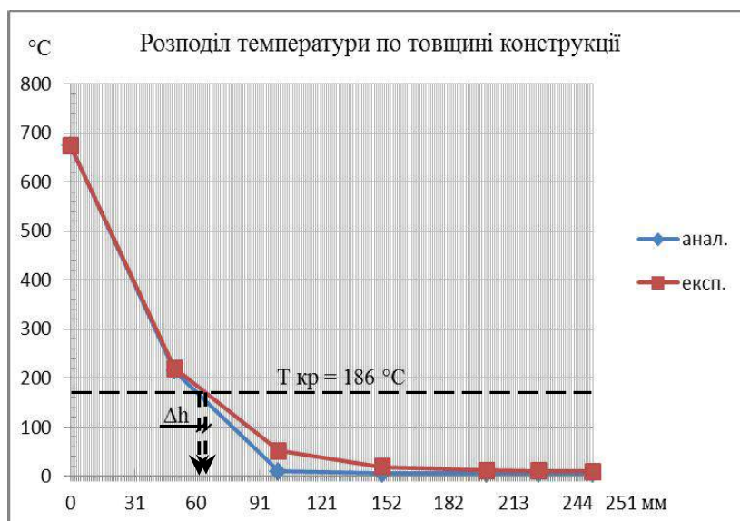
Рисунок 4.28. Співставлення графіків теоретичних та експериментальних досліджень огорожувальної конструкції марки СПППБ-2 на 100-ій хв
