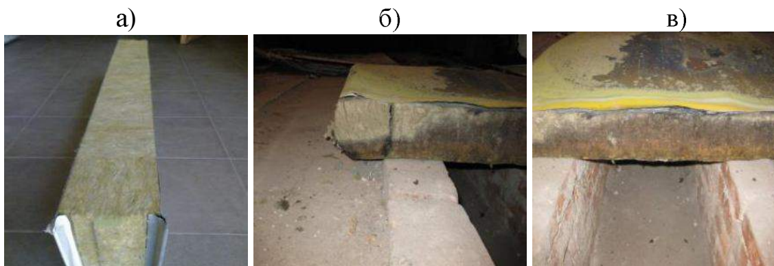
Рисунок 4.11. Вигляд зразка СПМ до і після випробування: а) до випробування; б) після випробування СПМ-1; в) після випробування СПМ-2
