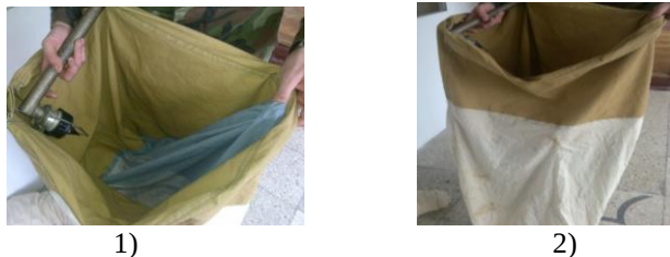
Рисунок 7.14. – Загальний вигляд ПГУ-120 для ДП-7 та ДП-10: 1– трубопровід із розпилювачем та сіткою; 2–перкалевий рукав
