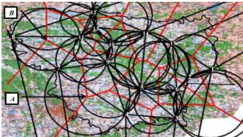
Рис. 6.6. Вибір місця для розташування нових пожежно-рятувальних частин на території Малого Полісся у Львівській області за радіусами описаних кіл навколо трикутників Делоне (див. рис. 6.5 а)
