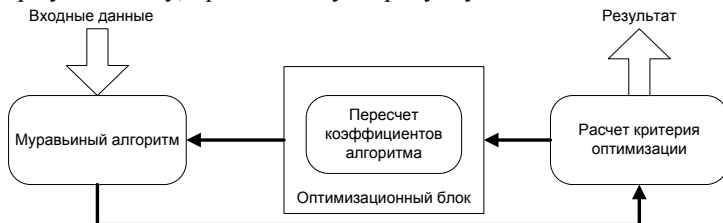
Рис.1. Схема рішення завдання оптимізації роботи виробничої ділянки з використанням мурашиного алгоритму
