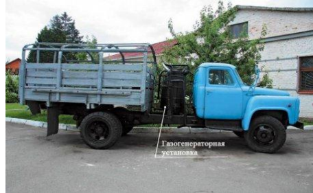
Рисунок 1. Схема газогенераторної установки (а):
