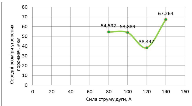
Рисунок 2 – Графік залежності середніх розмірів утворених порожнеч від сили струму дуги напilenня
