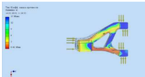
Рисунок.4 – Розподіл коефіцієнта запасу міцності по ділянках деталі в процесі дії навантаження.
