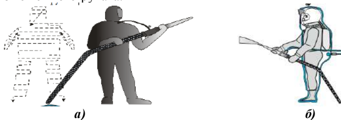
Рис. 1. Схема системи охолодження теплозахисного костюма пожежника: а – внутрішня гідравлічна система; б – система живлення охолоджувальних трубок.
