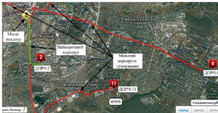
Рис. 1 – Пример определения кратчайшего маршрута следования подразделений к месту вызова
