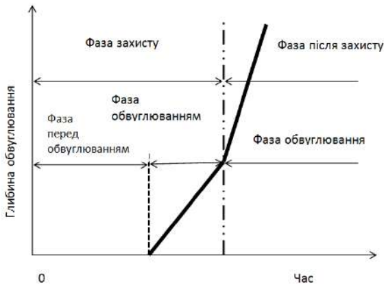
Рис. 1. Фази обвуглювання захищеної деревини
