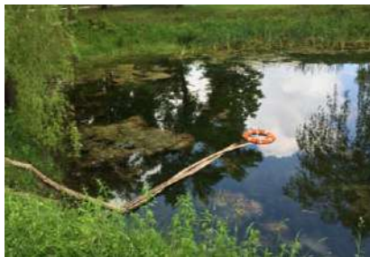
Рисунок 1 – Експериментальне дослідження плавучості гідроелеватора із рятувальним кругом
