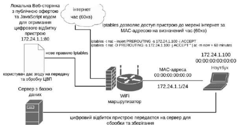
Рис. 2. Структурна схема дозволу доступу до мережі інтернет
